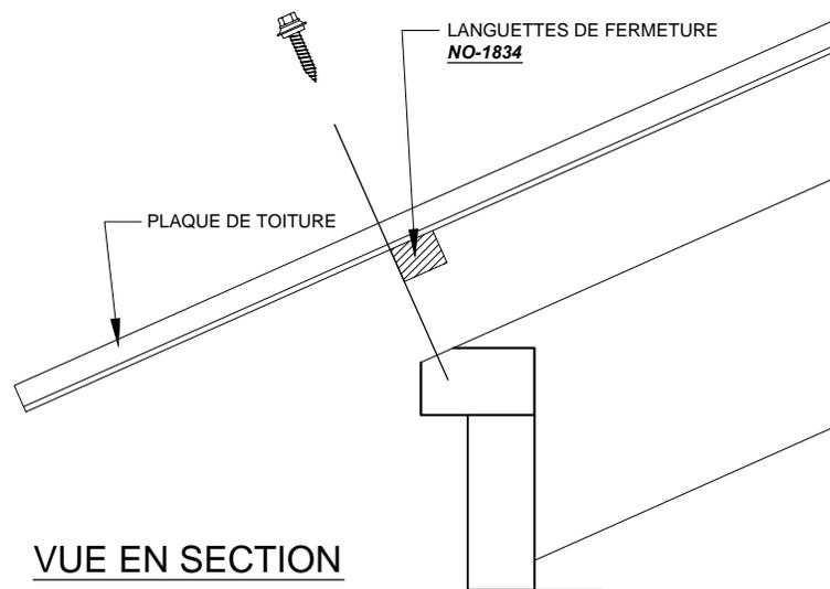
PLACER LES QUATRE PLAQUES DE TOITURE UNIFORMÉMENT SUR LES LATTES DU FOND DE CLOUAGE, COMME INDIQUE L'ILLUSTRATION. DISPOSER LES PLAQUES DE FAÇON QU'ELLES SURPLOMBENT UNIFORMÉMENT LA PARTIE INFÉRIEURE DU TOIT EN LAISSANT VOIR ENVIRON 1/2 PO DES LATTES SUPÉRIEURES.
