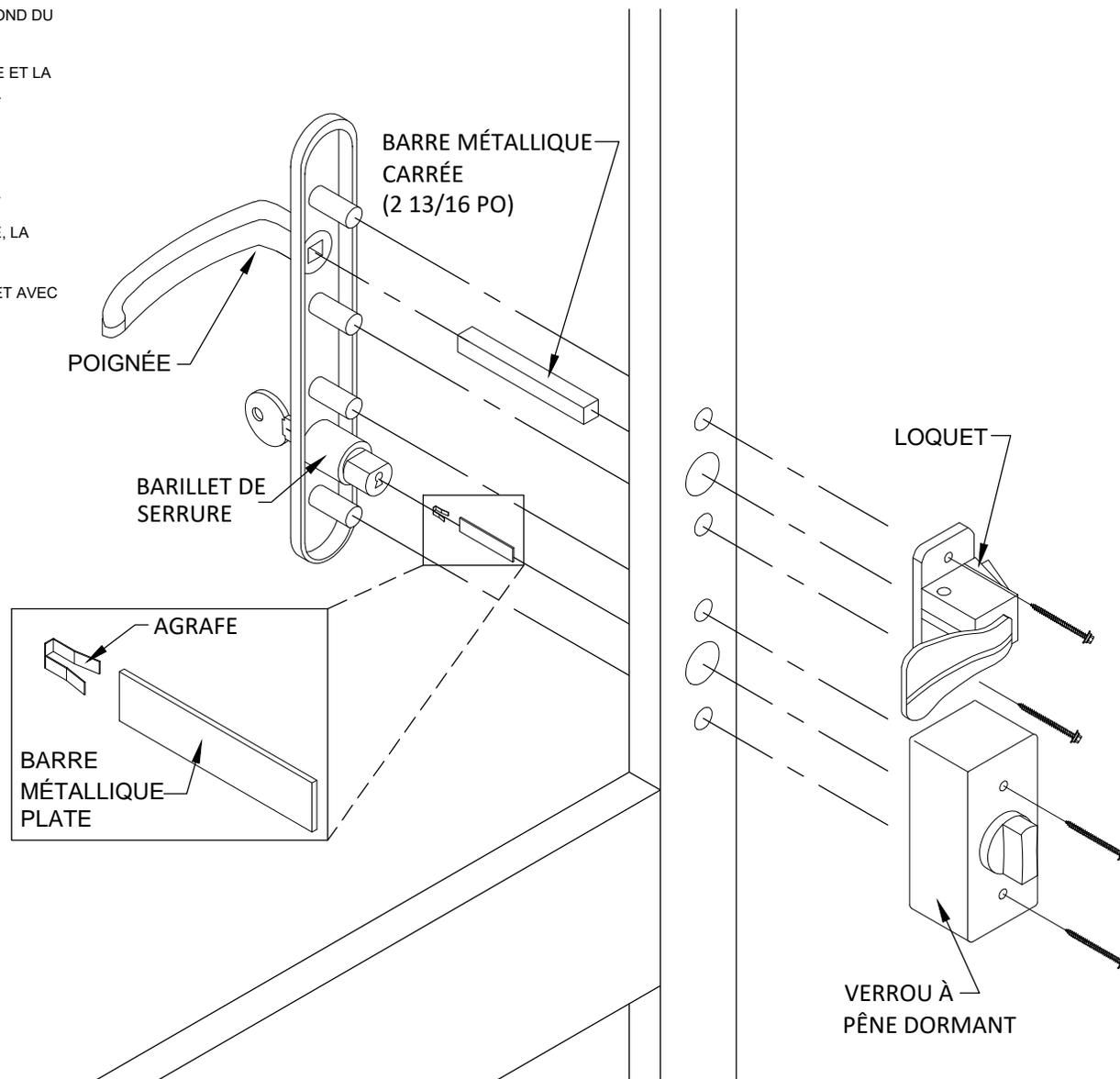
PASSER LES 2 BOULONS MÉCANIQUES DE 1 ¼ PO À TRAVERS LES TROUS DE LA PORTE PASSIVE GAUCHE (EN ALLANT DE L'EXTÉRIEUR VERS L'INTÉRIEUR).
