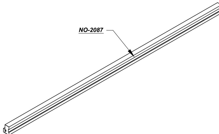
DISPOSER LE MONTANT DE LA PORTE GAUCHE (NO 2081) SUR LE LINTEAU (NO 2086) ET LE SEUIL DE PORTE (NO 2087). FIXER LA PORTE AU LINTEAU ET AU SEUIL À L'AIDE DE VIS DE 2 ½ PO.
