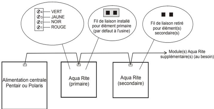
Hayward – Raccorder les fils aux bornes appropriées conformément à l'illustration ci-dessous.
