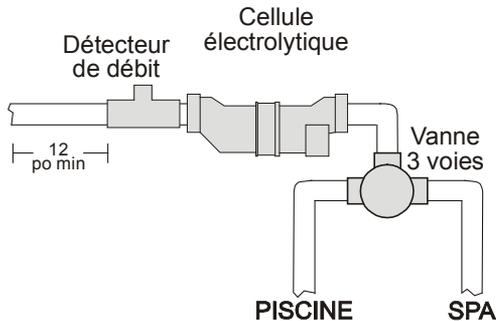
**Commutateur de flux :** IMPORTANT : un tuyau droit d'au moins 12 po (25 cm) doit être installé devant (en amont) du commutateur de flux. Pour assurer le bon fonctionnement du système, assurez-vous que la flèche du commutateur (située sur le haut de l'hexagonal gris) est orientée dans la direction du flux d'eau.
