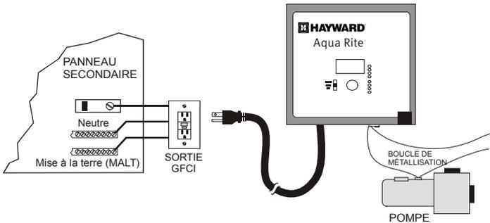
*Connexion* : Une cosse destinée au liage électrique est fixée au bas du boîtier du système (voir le schéma ci-dessous). Le système AquaRite doit être raccordé avec du fil de cuivre de calibre 8 AWG (6 AWG au Canada) au système électrique de la piscine.
