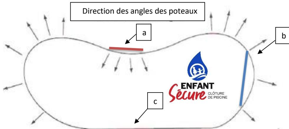
Les trous sur une ligne seront percés de façon parfaitement verticale. Utilisez le niveau pour plus de précision, vous pouvez en coller un sur le dessus. Pour incliner les poteaux vous devez percer dans un certain angle.
