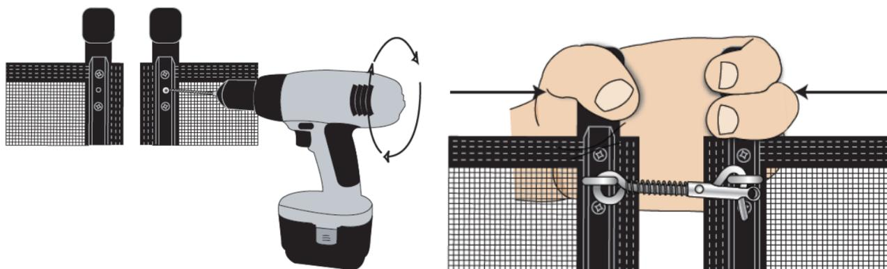
Rappelez-vous que chaque section de clôture (15') est reliée ensemble. Entre 2 sections, laissez un espace de 2½" entre les 2 poteaux afin d'y installer le crochet (centre/centre du trou). Les deux extrémités de la clôture doivent s'attacher à un mur, à une clôture ou à n'importe quel support solide, afin que la clôture soit tendue. Si vous n'avez pas de surface sûre et solide, vous pouvez utiliser un ***poteau de terminaison*** pour mettre la clôture sous tension.
