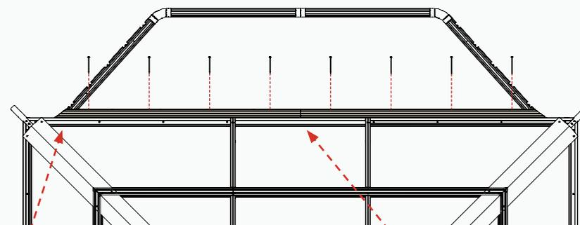
Les angles des chevêtres doivent être alignés avec le haut des panneaux.
