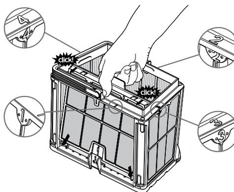
**6.2.5** Remettez les panneaux de filtrage en place dans l'ordre suivant: 4→3→2→1.
