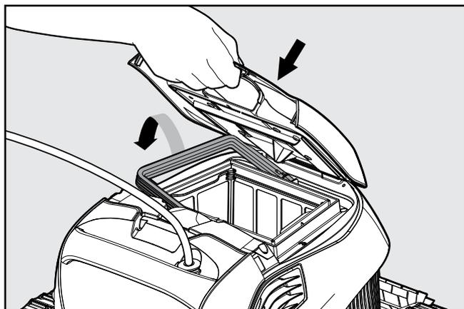
**6.2.6** Replacez le panier de filtrage intérieur, réinsérez l'assemblage de filtrage dans le nettoyeur et fermez le couvercle.
