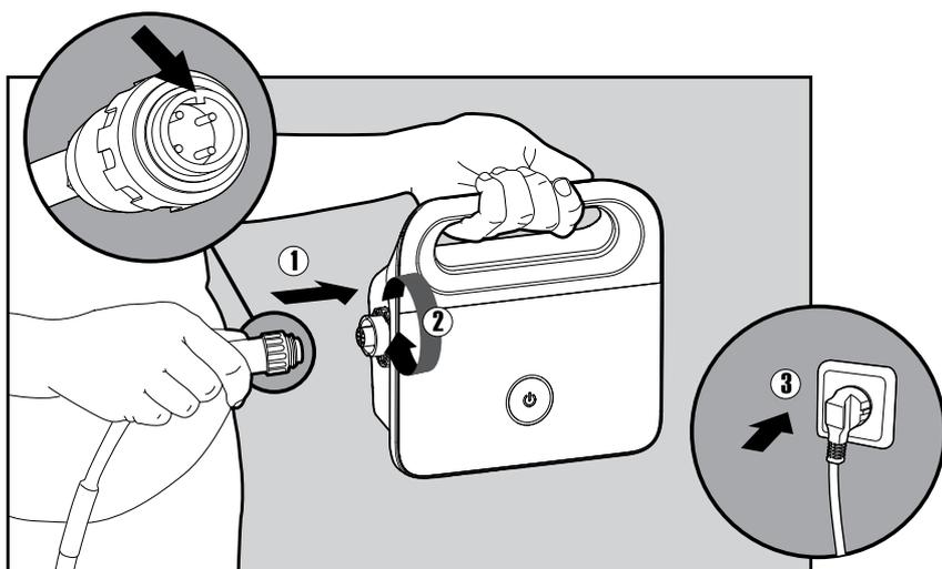
**5.1.3** Connectez le câble flottant à l'alimentation, alignez l'ergot du connecteur avec l'encoche de la prise sur l'alimentation (1), puis tournez dans le sens des aiguilles d'une montre (2). Branchez l'alimentation sur une prise de courant, en la laissant sur la position éteinte (3).
