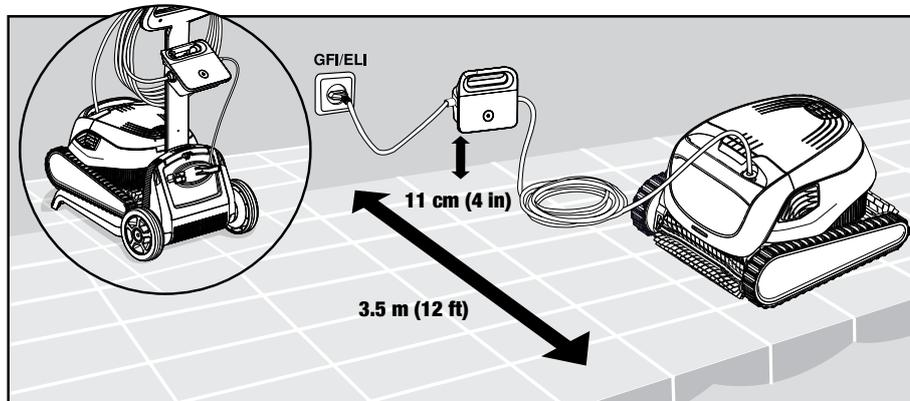
**5.1.1** Positionnez le bloc d'alimentation de manière à ce qu'il soit à peu près au milieu de la longueur de la piscine à une distance minimale de 3,5 m (12 ft) de la piscine et placé à 11 cm (4 in) au-dessus du sol.
