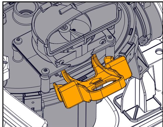
4. Insérez l'outil de sécurité/protection de la turbine.
