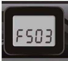
Après avoir programmé l'horloge, vous passerez au paramètre de l'heure de démarrage du cycle de filtration. L'écran affichera Fdxx, avec le « xx » représentant l'heure de démarrage du cycle. Servez-vous des touches de flèche pour ajuster les heures. Appuyez sur la touche de lumière pour passer au prochain paramètre, soit la durée du cycle de filtration (Fd).
