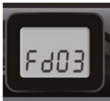
L'écran affichera Fdxx, avec le « xx » représentant la durée du cycle de filtration en heures. Servez-vous des touches de flèche pour ajuster la durée. Appuyez sur la touche de lumière pour passer au prochain paramètre, soit la fréquence de filtration (FF).
