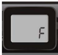
La température de l'eau peut être affichée en degrés Fahrenheit (<sup>o</sup>F) ou Celsius (<sup>o</sup>C). L'écran affichera soit <sup>o</sup>F ou <sup>o</sup>C. Servez-vous des touches de flèche pour modifier le réglage. Appuyez sur la touche de lumière pour enregistrer tous les paramètres.
