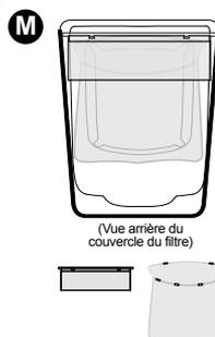
Installez le sac à débris propre sur les pinces du couvercle du filtre comme dans l'illustration (vous pouvez basculer le filtre d'écumage et utilisez l'endos pour en prolonger l'utilisation).
