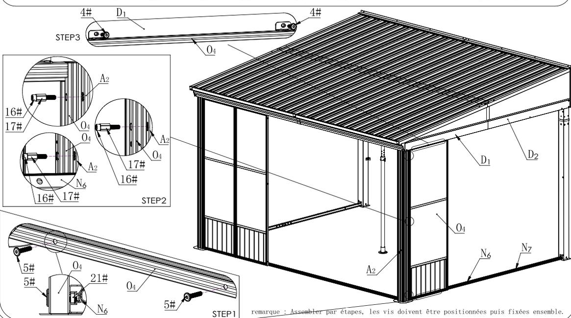
remarque : Assembler par étapes, les vis doivent être positionnées puis fixées ensemble.
