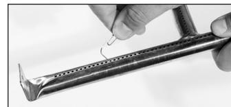
**ÉTAPE 06** Remplacez soigneusement les brûleurs et rattachez-les, en faisant attention à l'emplacement de l'aiguille d'allumage.
