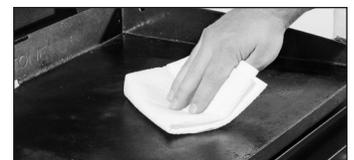
**ÉTAPE 03** Appliquez quelques cuillères à soupe d'eau sur la surface de la plaque chauffante, puis raclez l'eau et les débris dans le bac à graisse. (Pour les résidus alimentaires collés, utilisez un peu de gros sel.)
