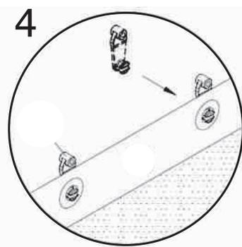
2, 3, 4: Insérer 14 crochets (4#) dans la rail extérieur des moulures (B2 et C2) (7 chaque côté) vers l'intérieur et 24 crochets (4#) dans la rail extérieur des moulures (D2 et E2) (12 chaque côté) vers l'intérieur tel qu'illustré.
