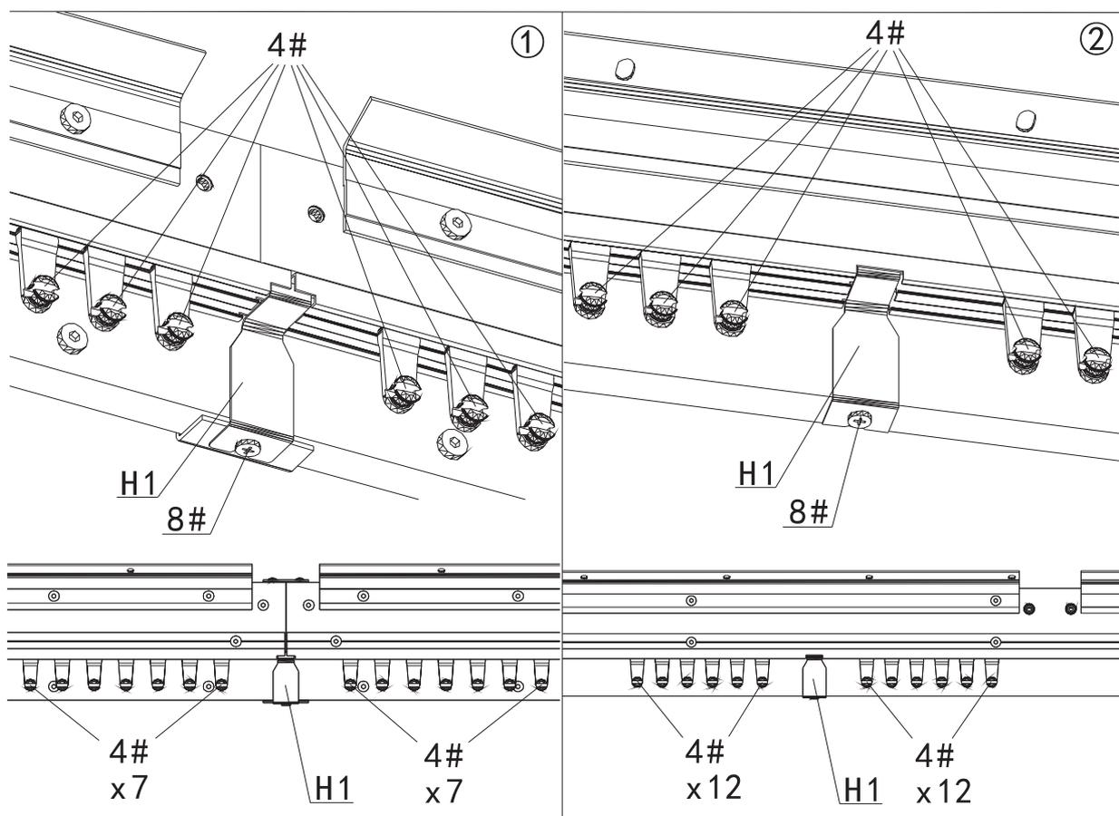
Insérer 14 crochets (4#) dans la rail intérieur des moulures (B2 et C2) (7 chaque côté) vers l'intérieur et 24 crochets (4#) dans la rail intérieur des moulures (D2 et E2) (12 chaque côté) vers l'intérieur tel qu'illustré.
