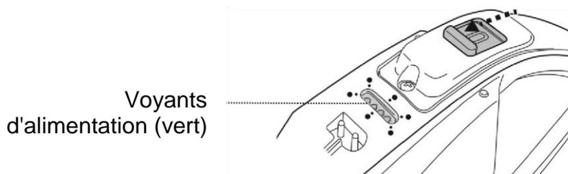
3. Plonger le robot dans l'eau, le moteur se met en marche automatiquement lorsque le niveau d'eau recouvre les capteurs situés en haut de la tête pivotante. Laisser le robot s'enfoncer au fond de la piscine puis observer ses mouvements avant et arrière. Si le robot se déplace le long de la paroi de la piscine plutôt que perpendiculairement, le repositionner en s'assurant que l'avant/arrière fait face à la paroi de la piscine.
