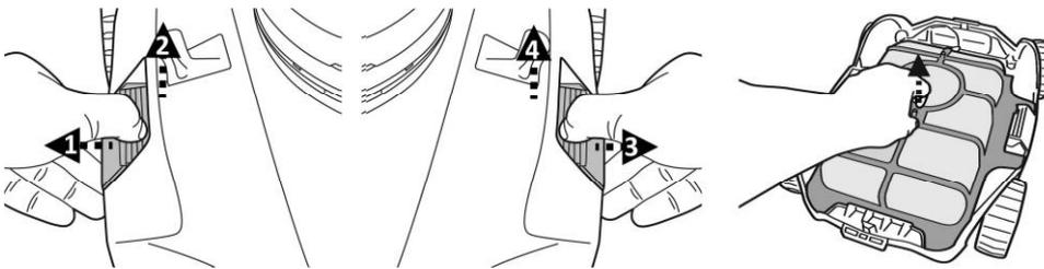
2. Retirer le couvercle filtrant et vider les débris du compartiment. Il est recommandé de nettoyer les mailles du couvercle filtrant à l'aide d'un jet d'eau. Si un brossage est jugé nécessaire, utiliser uniquement une brosse douce pour un nettoyage avec précaution et en douceur, ceci afin d'éviter tout dommage.
