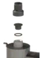
**Pressure Test Cap Installation**
