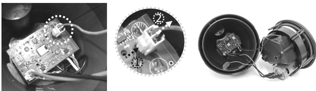
5. Desserrer les 3 vis pour libérer le couvercle du compartiment de batteries. Retirer le bloc de batteries du compartiment.
