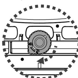
Nota: No retire la placa del filtro de drenaje. Sin ella, los restos saldrían del compartimento de escombros de la base cuando el dispositivo estuviera en funcionamiento.
