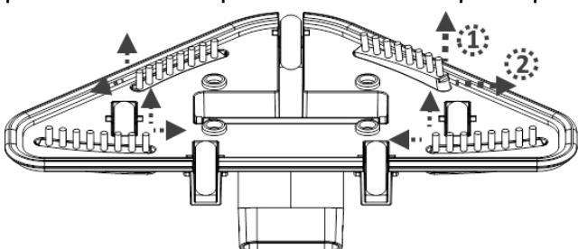
**AVERTISSEMENT !** Pour les piscines en fibre de verre et avec une doublure en vinyle, il est recommandé de laisser les brosses sur la tête d'aspiration afin d'éviter d'endommager la piscine.
