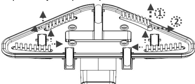
**¡ATENCIÓN!** En el caso de piscinas revestidas de vinilo o piscinas de fibra de vidrio, se recomienda mantener los cepillos en el cabezal de succión para evitar dañar la piscina.
