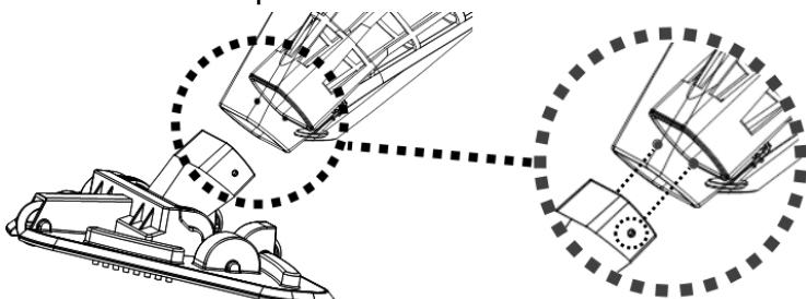
NOTA: Para sustituir los cepillos del cabezal de succión, levante el extremo y tire de él para dejar espacio para uno nuevo.
