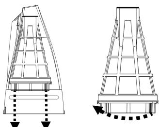
4. Rincer le coffret transparent et nettoyer les débris à l'intérieur du cône filtrant. Il est recommandé de nettoyer le filet du cône filtrant avec une projection d'eau. Si un brossage est considéré nécessaire, utiliser uniquement une brosse douce pour le nettoyer avec soin et précaution. N'APPLIQUER aucune pression au filet.
