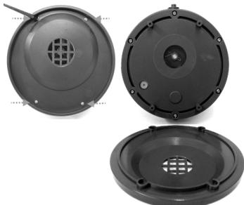
3. Desserrer les 6 vis et séparer le couvercle pour laisser à découvert le PCBA, le groupe moteur et le bloc de batteries.
