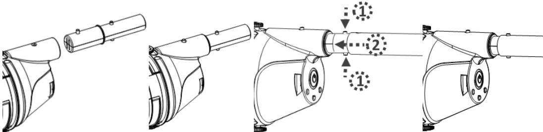
Para liberar la pértiga telescópica, pulse los dos pasadores laterales simultáneamente y tire de la pértiga.
