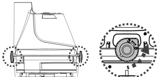
3. Faire basculer le coffret transparent et s'assurer que la plus petite extrémité est orientée vers le haut, ensuite pousser le cône filtrant hors du coffret transparent. Tenir le cône filtrant horizontalement et tourner son couvercle dans le sens horaire pour le séparer du cône.
