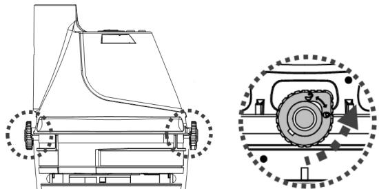
2. Placer le corps arrière (renversé - bouton marche/arrêt face en dessus) sur une surface plate. Ouvrir le bouchon protecteur du dessus du corps et aligner les 2 branches de la base du chargeur au dessus des orifices de recharge. **AVERTISSEMENT !** S'assurer de ne pas inverser la position de la base du chargeur. Appuyer la base du chargeur dans le corps arrière jusqu'à ce que les branches soient branchées dans les orifices.
