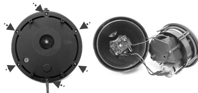
4. Para desconectar el cable de la batería, presione el clip del conector y tire de él. NOTA: Envuelva inmediatamente el conector con cinta aislante para evitar cortocircuitos causados por el contacto de los dos polos del cable.
