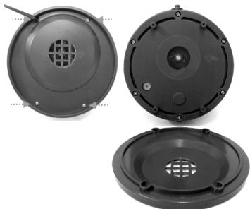
3. Desatornille los 6 tornillos y retire la cubierta para acceder al PCBA, al conjunto del motor y al paquete de la batería.
