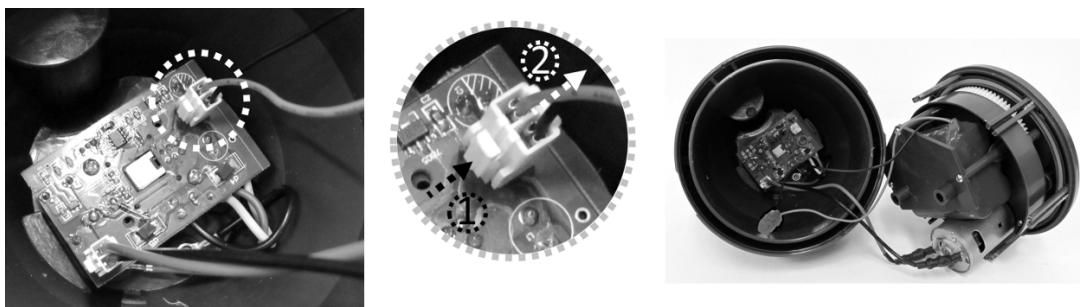
5. Desatornille los 3 tornillos para liberar la cubierta del compartimento de la batería. Saque el paquete de baterías del compartimento.
