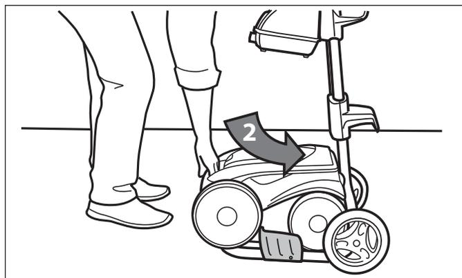
Figure 29. Installer correctement le nettoyeur sur le chariot
