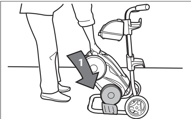
Figure 28. Positionner le nettoyeur sur le chariot
